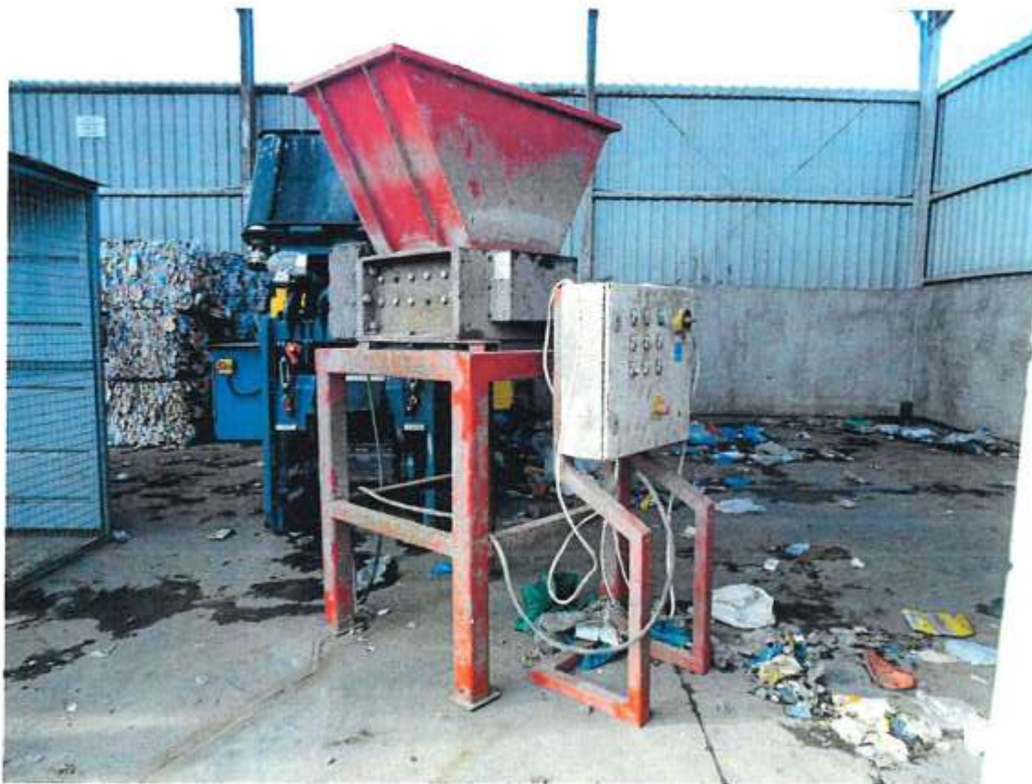
3. Rozdrabniacz odpadów dwuwałowy CASTOR 600, nr ser. 01/2011
