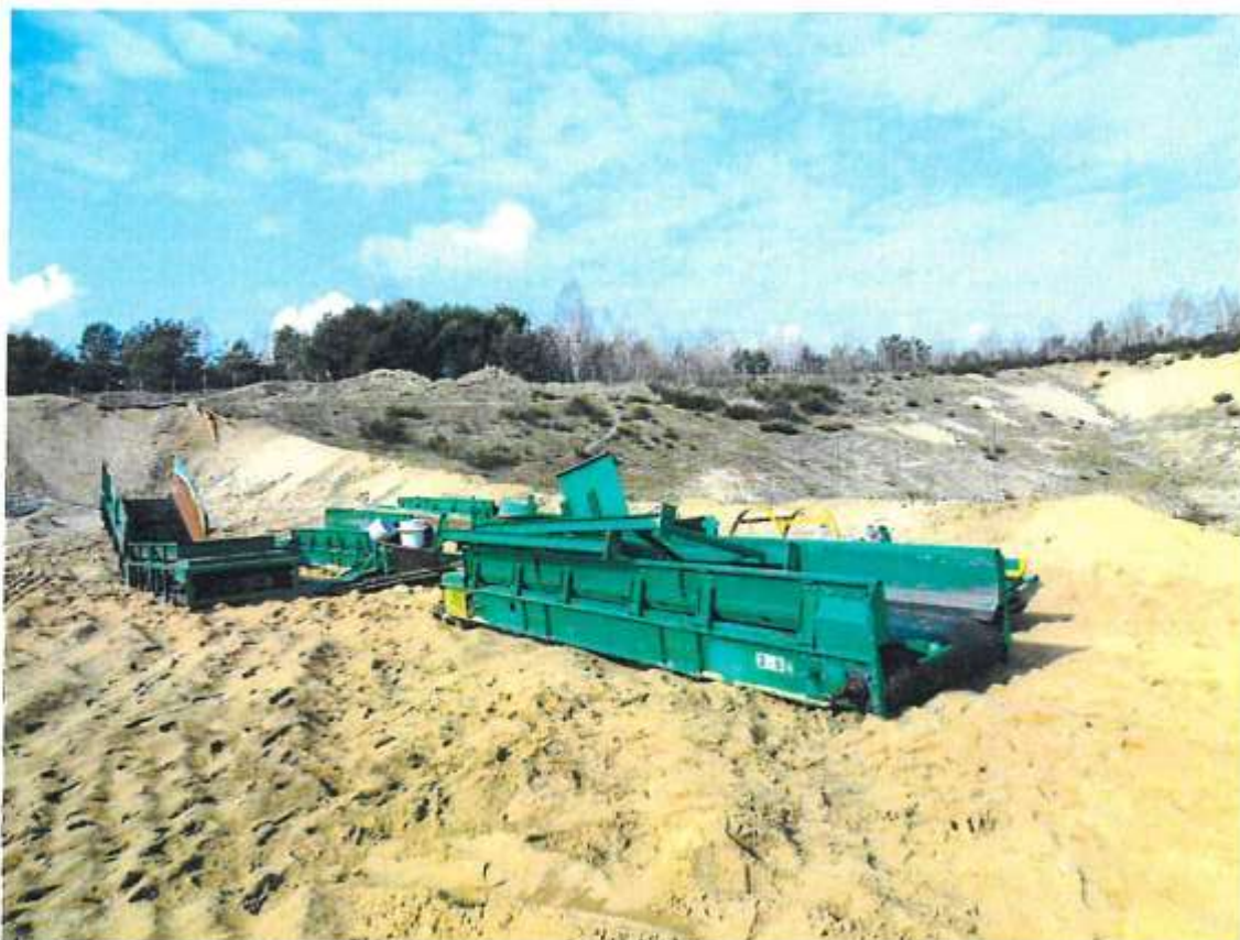
11. Zdemontowane przenośniki taśmowe z linii sortowniczej – 3 szt.
